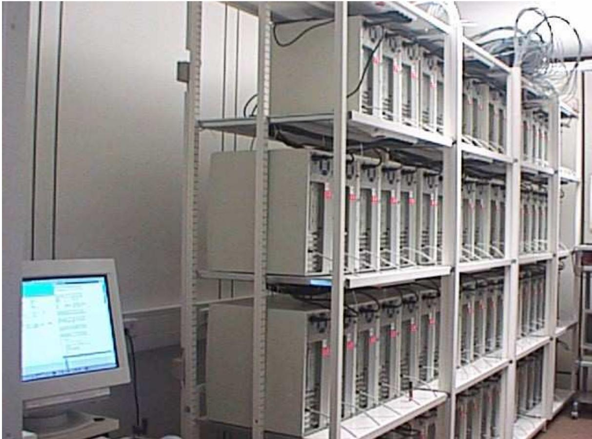
Abbildung 3.12: Ein PC Cluster mit 80 Prozessoren am IWR der Universität Heidelberg.
