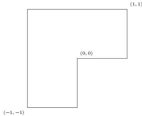
Auf dem in der Abbildung dargestellten Gebiet  $\Omega$  soll das Laplace-Problem  $\Delta u = 0$  gelöst werden. Auf dem gesamten Rand werden Dirichlet-Randbedingungen verwendet, welche gemäß  $u|_{\partial\Omega} = g|_{\partial\Omega}$  durch die harmonische Funktion
