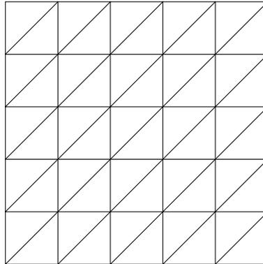
Die Anzahl der Unterteilungen in  $x$ - und  $y$ -Richtung bezeichnen wir mit  $N$  (im Bild  $N = 5$ ), die Gitterweite ist  $h = \frac{1}{N}$ . Die Knoten nummerieren wir beginnend im Koordinatenursprung zeilenweise von 0 bis  $N^2 - 1$ . Geben Sie eine Zeile der Steifigkeitsmatrix an, die zu einem inneren Gitterpunkt gehört. 10 Punkte
