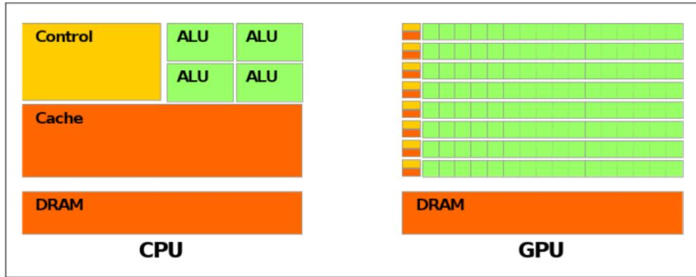
GPU weitaus mehr Transistoren für Datenverarbeitung, dafür weniger Transistoren für Cache
